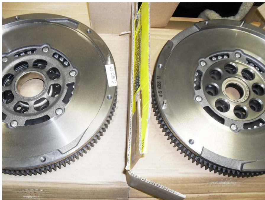
Рис. 1: Рис 1: LuK ZMS 415 0388 10 с подшипником скольжения (слева) и шарикоподшипником (справа)
